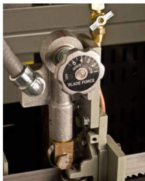
Control Automático de Fuerza de Corte
